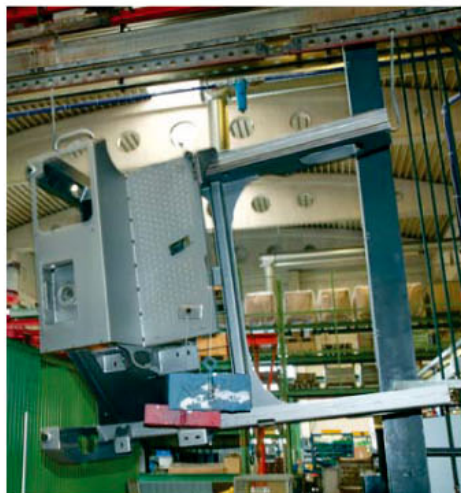
Particolare sabbiato di un muletto al seguito CRAYLER prima della verniciatura a immersione
