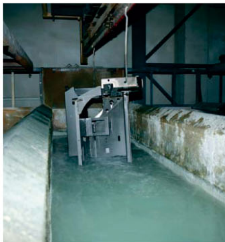
Pretrattamento: pretrattamento a spruzzo e immersione in 9 zone con fosfatazione allo zinco
