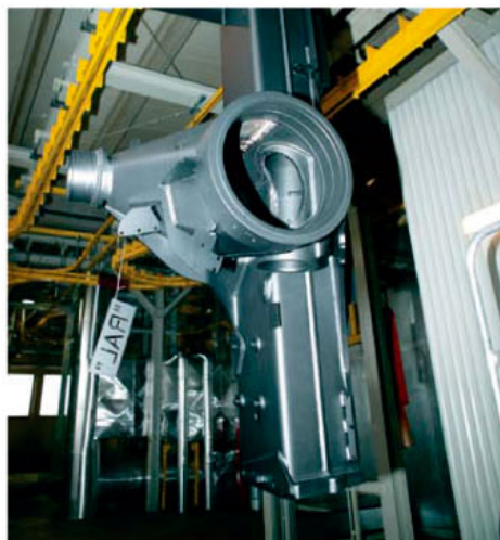
Telaio di base dopo il trattamento di sabbia- tura con graniglia metallica pronto per essere immerso
