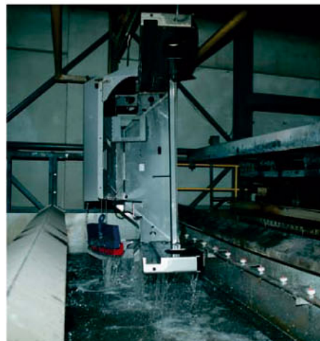
Pretrattamento: pretrattamento a spruzzo e immersione in 9 zone con fosfatazione allo zinco
