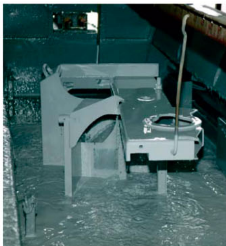
Mano di fondo: verniciatura ad immersione per cataforesi in 3 zone con vernici solubili in acqua
