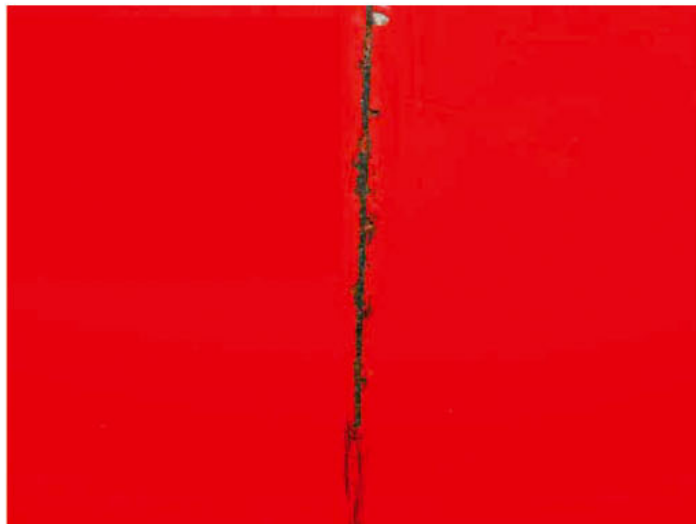
Superficie CON rivestimento KTL dopo 1152 ore di prova alla nebbia salina
