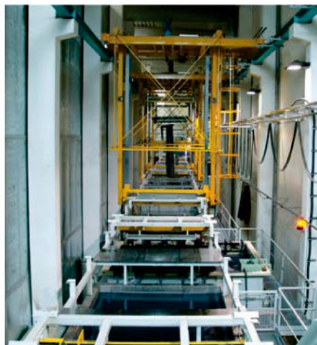
Nelle singole vasche (13 in tutto) i componenti delle gru vengono sgrassati, lavati, attivati, fosfatati allo zinco, risciacquati, passivati e, dopo un risciacquo con acqua pura subiscono il trattamento elettrostatico KTL per immersione
