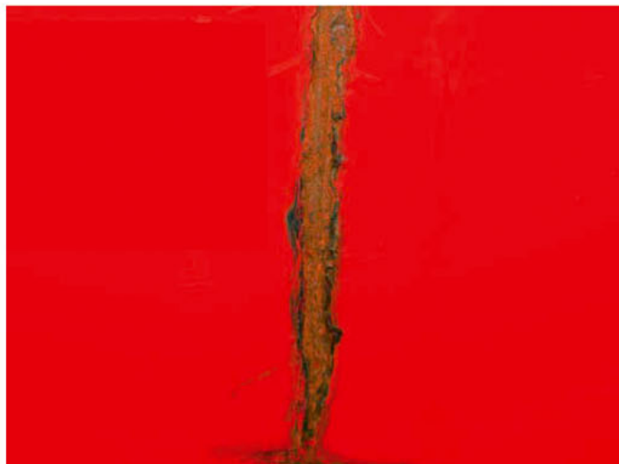
Superficie SENZA rivestimento KTL dopo 700 ore di prova alla nebbia salina
