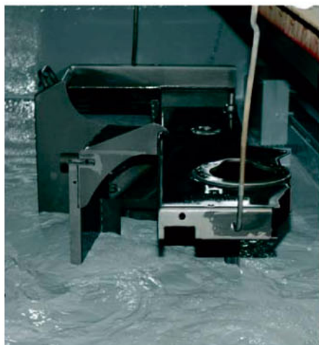
Mano di fondo: verniciatura ad immersione per cataforesi in 3 zone con vernici solubili in acqua
