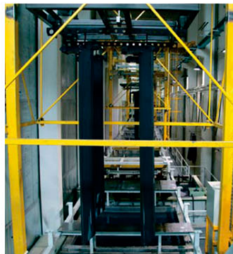
Nelle singole vasche (13 in tutto) i componenti delle gru vengono sgrassati, lavati, attivati, fosfatati allo zinco, risciacquati, passivati e, dopo un risciacquo con acqua pura subiscono il trattamento elettrostatico KTL per immersione
