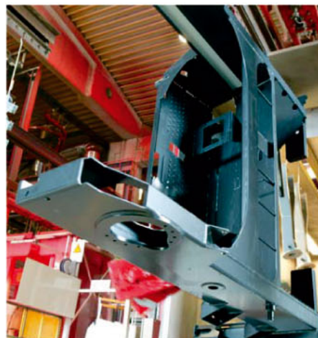
Particolare CRAYLER con verniciatura a finire; pronto per l'assemblaggio
