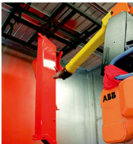
Verniciatura a finire con vernici bicompo- nenti, ecologiche, solubili in acqua
