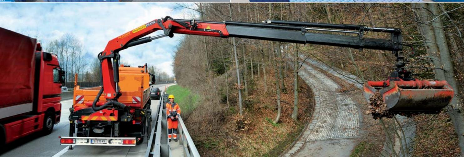
„HPSC“ significa per il gruista un massimo di comfort d'uso e di sicurezza – anche per gli impieghi della gru in condizioni di spazio ristrette. In zone densamente edificate, nel traffico ininterrotto o in simili situazioni il veicolo può spesso essere stabilizzato su un solo lato o anche per niente.
