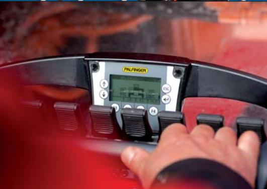
Il sistema HPSC calcola per ogni angolo di rotazione del sistema bracci e per qualsiasi situazione di posizionamento degli stabilizzatori il campo di lavoro consentito. Basato su un intelligente algoritmo di calcolo, sviluppato da PALFINGER, questo opera con maggiore efficienza rispetto ai sistemi paragonabili disponibili sul mercato.
