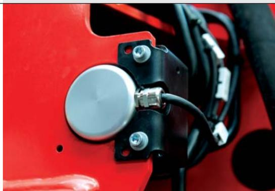
Anche gli stabilizzatori ausiliari sono provvisti di sensori di posizione proporzionali, integrati nel sistema HPSC, risultante in un efficiente sistema complessivo.
